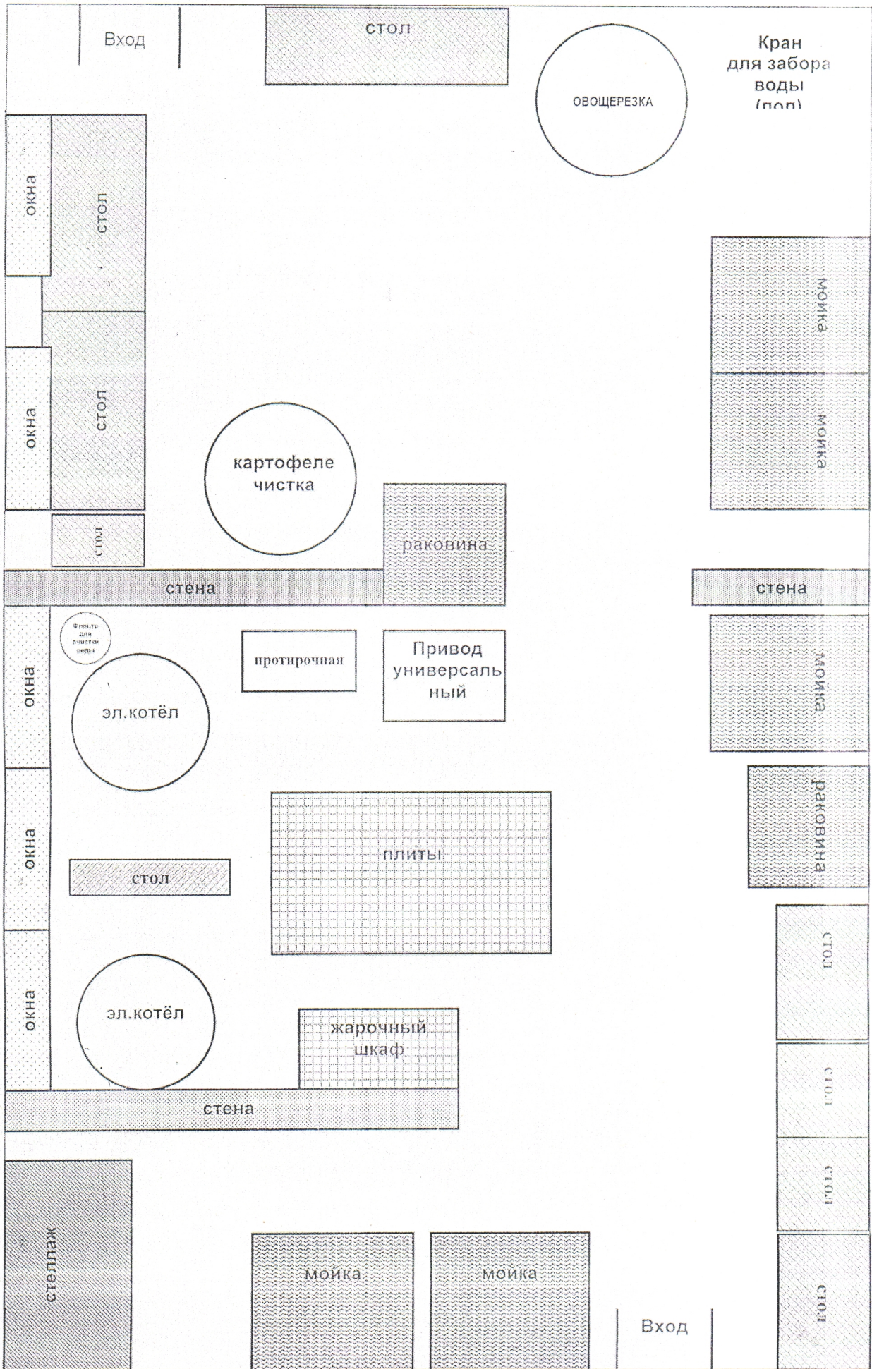
Схема пищеблока Д/с № 10 «Теремок» с расстановкой оборудования
